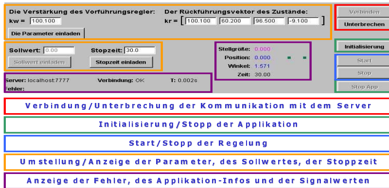
Bild 3: ‚Control Applet‘ zum Laborversuch „Brückenkran“
